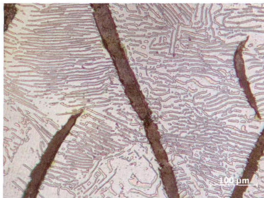
图九 片状石墨、层片状珠光体与铁素体, 高倍, 腐蚀
