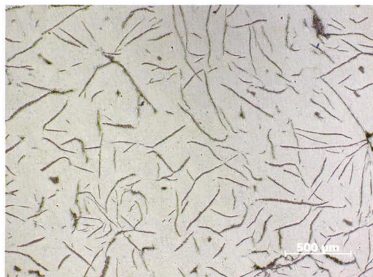
图五 片状石墨与金属基体，低倍，未腐蚀
