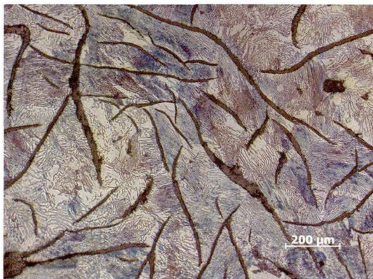
图八 片状石墨与珠光体组织，高倍，腐蚀
