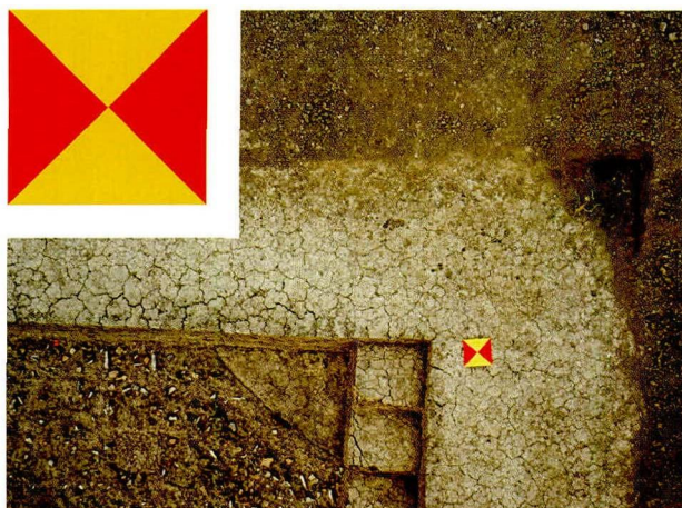
图一 控制点标志与带有控制点标志的影像
