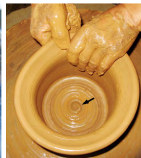
图一一 内底螺旋式拉坯指印和乳钉状突起
