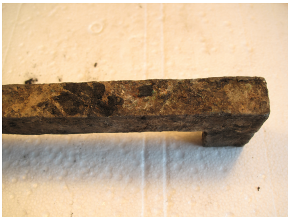
图三〇 M1:31 铜构件上的铸造缺陷
